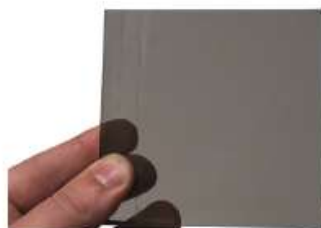
uitsnede bestaand getint glas glas in het lijf en de kroon getint brons, in de plint helder glas
