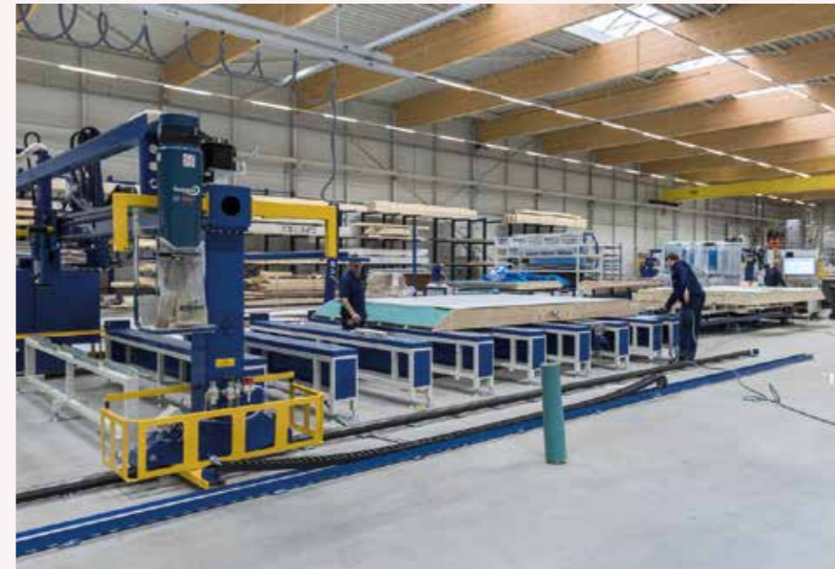
KAPPEN WORDEN IN BIM VOORBEREID EN GEPREFABICEERD ONDER IDEALE OMSTANDIGHEDEN (DEGROOT, VROOMSHOOP).
