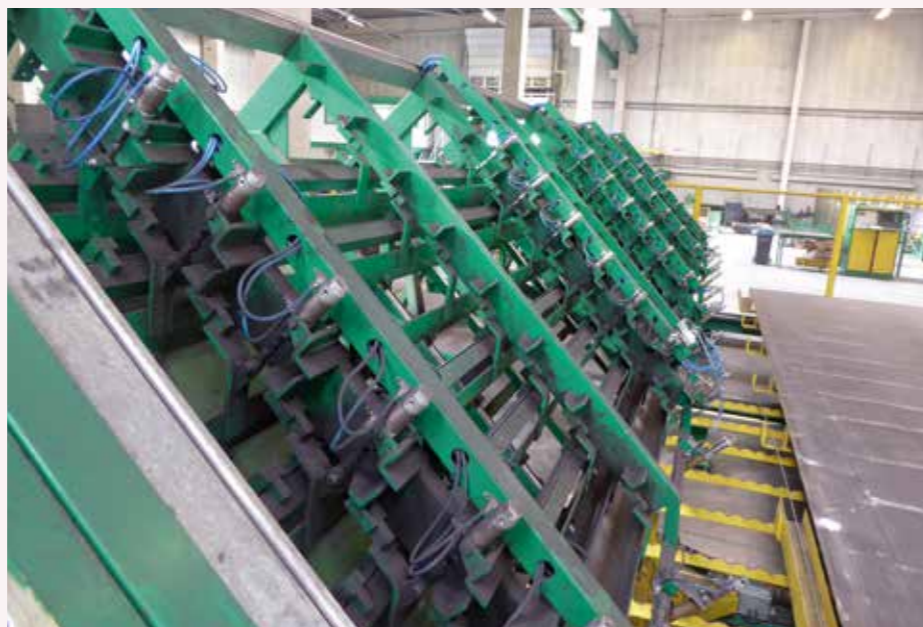
EEN GROTE 'BREIMACHINE' VOOR WAPENINGSTAAL (VOORBIJ, AMSTERDAM)
