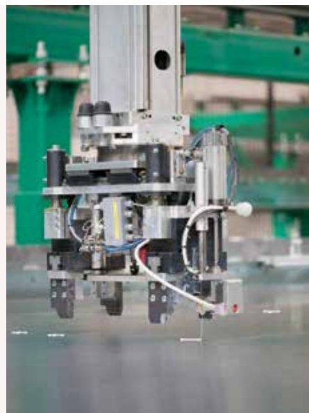
GEVELS WORDEN VOLAUTOMATISCH GEPLOT (VOORBIJ, AMSTERDAM).
